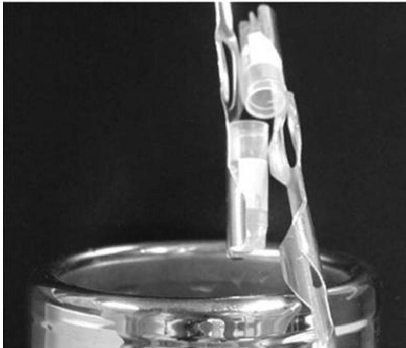
**Figura 3.** Foto representativa da técnica de DVC (*Direct Cover Vitrification*). A amostra submetida à vitrificação é coberta por N<sub>2</sub> líquido, proporcionando uma brusca redução na temperatura. Retirado de Chen et al., 2006.
