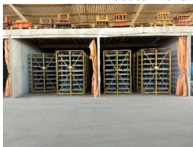
Figura 6 – Armazenamento dos blocos de concreto: a) Câmara para acelerar processo de cura; b) Produto final embalado e estocado.
