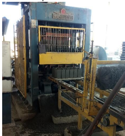
Figura 5 – Vibroprensa moldando os blocos.
