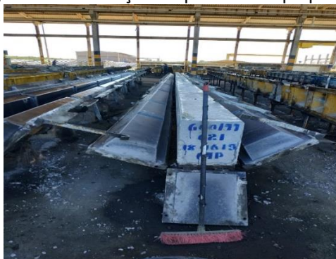
Figura 2 – Fabricação de postes do tipo padrão
