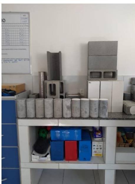
Figura 1 – Produção de corpos de prova para verificar a qualidade do concreto.
