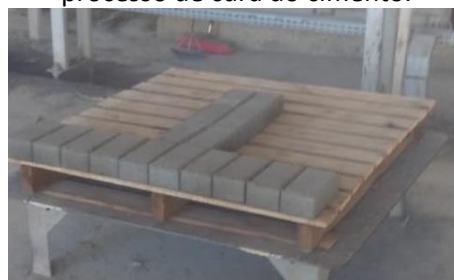
Figura 2 – Blocos prontos, em processo de cura do cimento.
