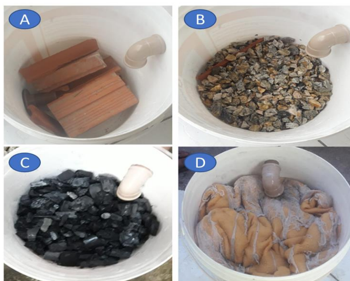
Figura 2 - Materiais utilizados para construção do filtro biológico.
