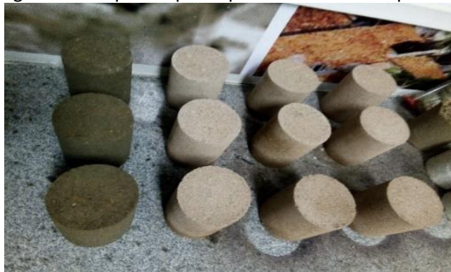
Figura 4 – Corpos de prova para o ensaio a compressão
