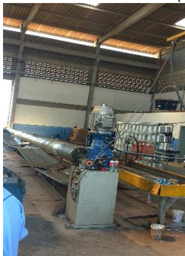
Figura 1 – Sistema de Enrolamento Filamentar ( Filament Winding ).
