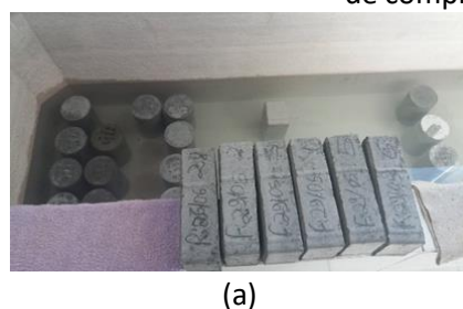
Figura 2 – Corpos de prova: a) Local de cura (tanque de cura) do CP's; b) CP's capeados ; c) Ensaio de compressão.
