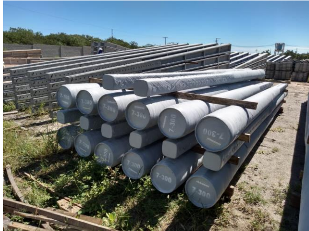
Figura 4 – Armazenamento das peças pré-moldadas.
