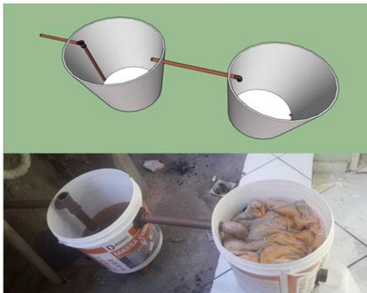
Figura 3 - Materiais utilizados para construção do filtro biológico
