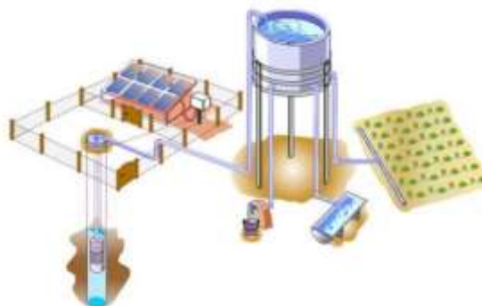
Figura 2 – Sistema fotovoltaico de bombeamento para consumo humano e irrigação
