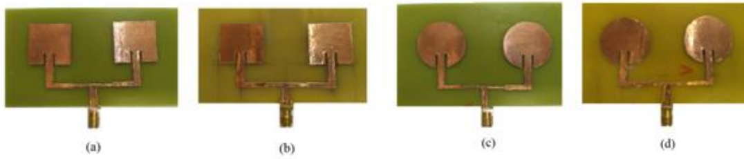
Fig.4. Arranjos (a) Retangular sem EBG, (b) Retangular com EBG, (c) Circular sem EBG e (d) Circular com EBG
