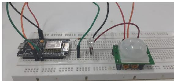
Figura 6. Circuito usando captar movimento do ambiente e controlar o ar-condicionado
