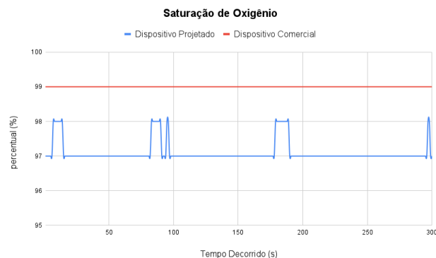
Fig. 7. Curvas com os valores da saturação de oxigênio captados pelo dispositivo projetado (azul) e dispositivo comercial (vermelha).
