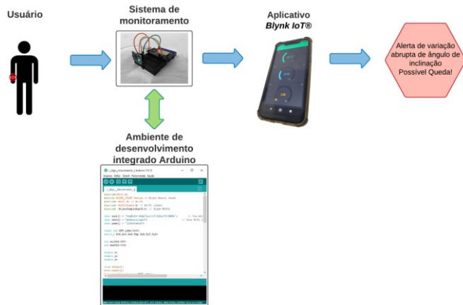
Fig. 2. Fluxograma geral da atividade do Sistema de monitoramento.
