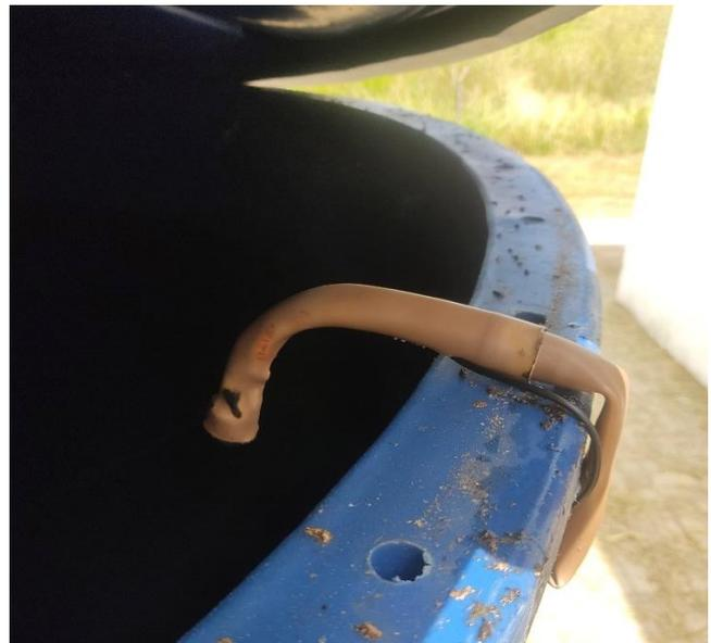
b) Sensor ultrassônico instalação interna na caixa d'água
