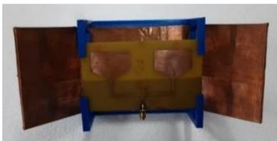
Fig. 7. Arranjo de antena de microfita e refletor utilizados no sistema de medição eletromagnético.
