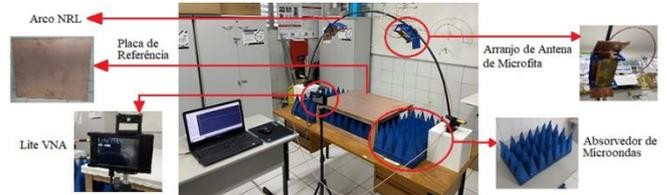
Fig. 8. *Setup* de medição construído para análise comparativa dos resultados simulados de medidos.
