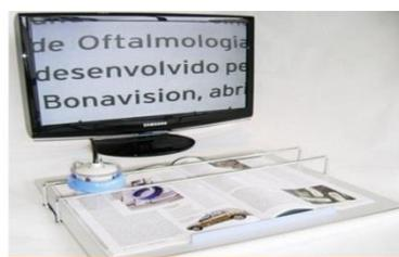
Figura 13: lupa eletrônica<sup>17</sup>
