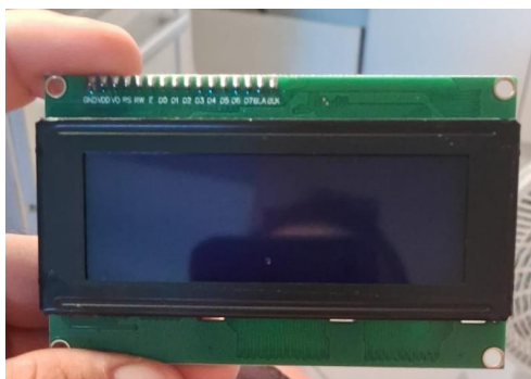
Fig. 7. Display interativo da lixeira inteligente.
