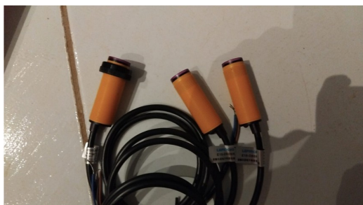
Fig. 5. Sensores de infravermelho utilizados na identificação dos resíduos recicláveis.
