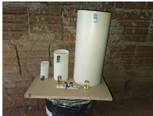
Fig. 8. Posicionamento dos sensores infravermelhos nas entradas da lixeira
