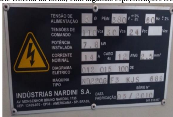
FIGURA 2. Placa externa com especificações (autoria própria).
