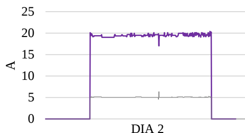
FIGURA 19. Dia 2 – Corrente elétrica do Cenário 1 antes e após a correção do fator de potência (autoria própria).
