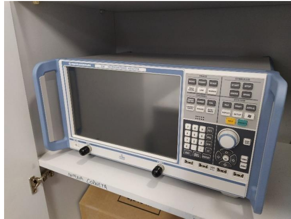
Fig. 16. Vector Network Analyzer utilizado para a medição da antena produzida. (Autoria própria, 2020)
