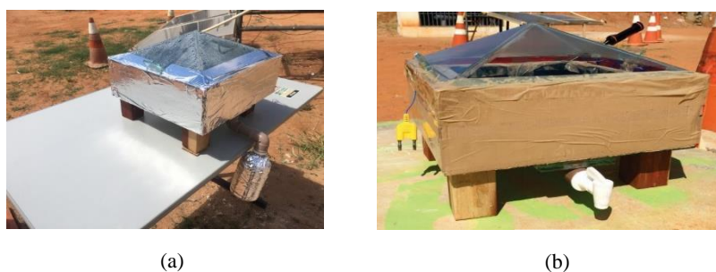
Figura 3 – Protótipo de dessalinizador solar antes e depois das modificações propostas. (a) protótipo modificado, (b) protótipo desenvolvido por [5]. Fonte: [13]
