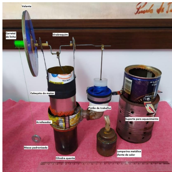
Figura 2. Protótipo construído e principais componentes. (Autoria própria)
