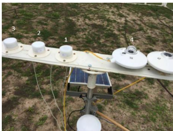
FIGURA 4. Protótipos de piranômetros com os difusores em teste e o piranômetro de referência, KIPP&ZONEN CMP22. (Autoria própria)
