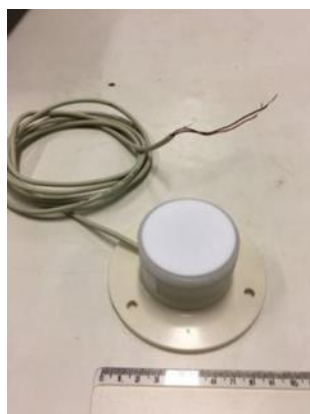
FIGURA 2. Corpo do piranômetro proposto com difusor de acrílico. (Autoria própria)
