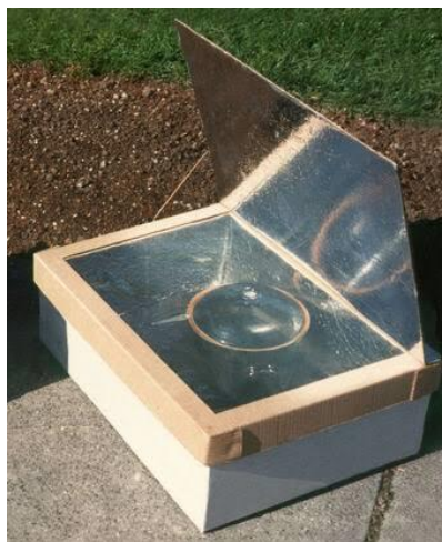
FIGURA 1. Fogão solar do tipo caixa [13].
