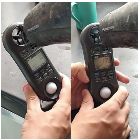
FIGURA 8. Testes da velocidade do vento com o anemômetro (Autoria própria).
