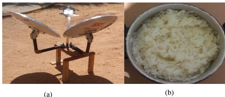
FIGURA 7. (a) Panela no ponto focal; (b) Porção de arroz cozido (Autoria própria).
