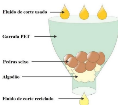
FIGURA 2. Diagrama esquemático do mesmo, identificando os materiais utilizados, bem como a trajetória do fluido utilizado, coletado durante o processo de filtração.
