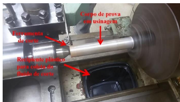
FIGURA 1. Posicionamento do recipiente de plástico acoplado à estrutura do torno em relação à peça de trabalho e à ferramenta de corte.
