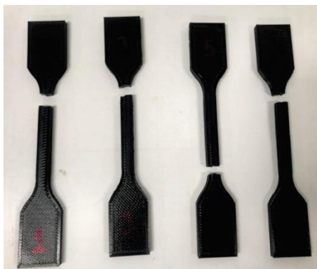
Figura 7. Comportamento à fratura de amostras de PLA para ensaio de tração.
