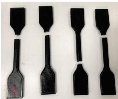
Figura 7. Comportamento à fratura de amostras de PLA para ensaio de tração.
