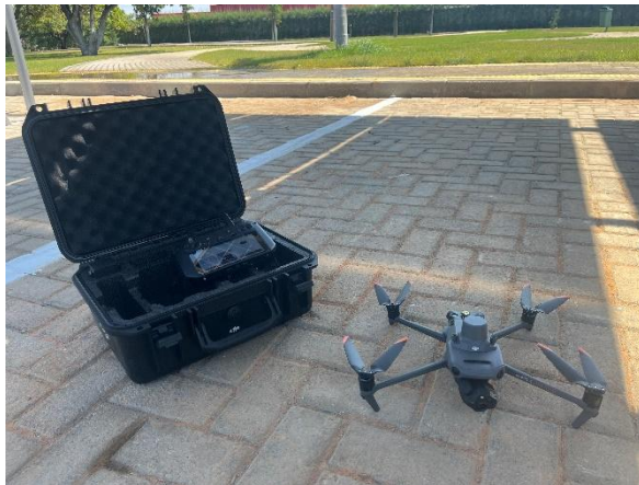
Figura 10. Drone térmico utilizado para inspeção (autoria própria).
