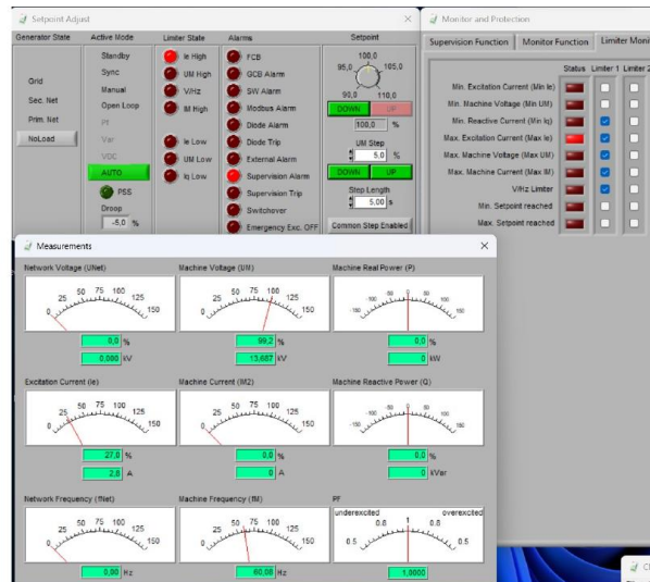
Figura 4.4: Atuação do limitador de sobrecorrente de excitação.
