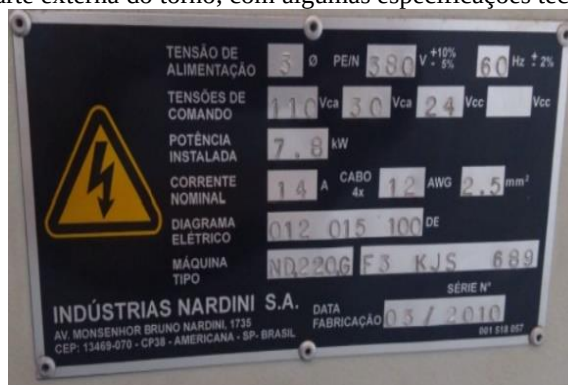
FIGURA 2. Placa externa com especificações (autoria própria).
