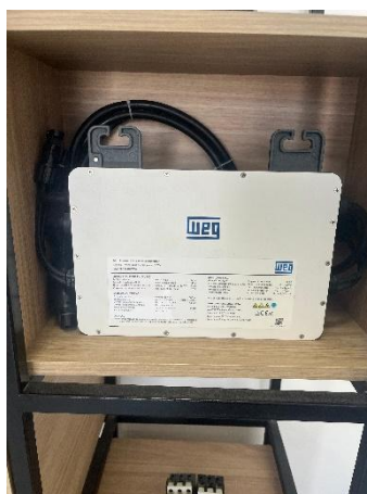
Figura 9. Imagem do microinversor utilizado na instalação (autoria própria).
