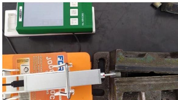
Figura 5- Configuração usada para o ensaio de rugosidade (Autoria Própria).
