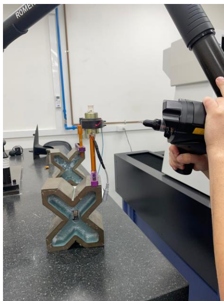
FIGURA 8. Utilização do braço scanner Hexagon (autoria própria).
