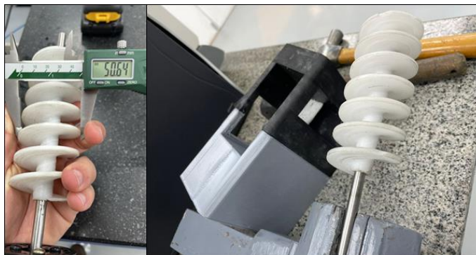
FIGURA 7. Alteração da rosca (autoria própria).
