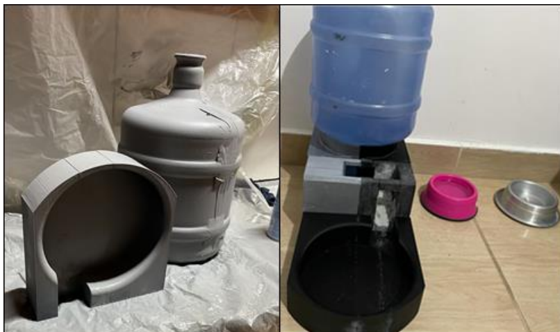
FIGURA 10. Utilização do primer e alimentador montado (autoria própria).
