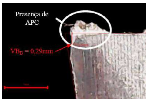
FIGURA 4. Nível de desgaste de flanco médio e APC formadas na Ferramenta 1.
