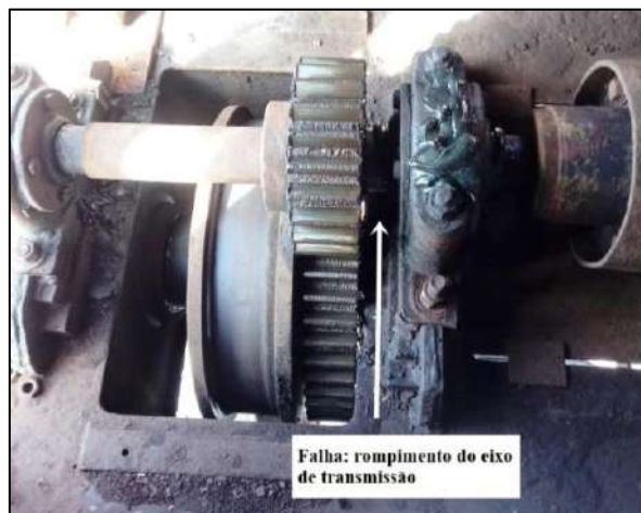
FIGURA 6. Rompimento do eixo com indicação do local da falha (autoria própria).
