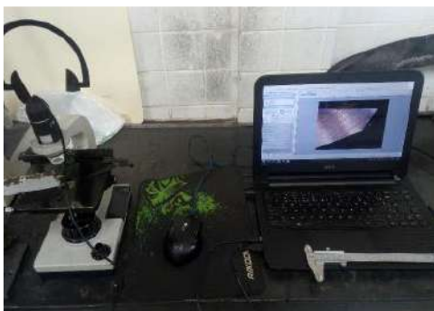
FIGURA 2. Fotografia do aparato montado para a medição do desgaste de flanco das ferramentas de corte.
