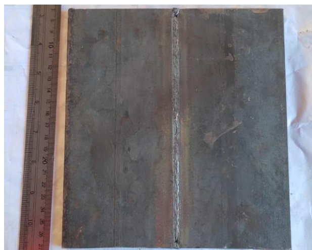
Figura 7. Inspeção da raiz de solda do CP (Autoria Própria)
