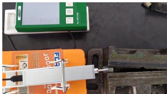
Figura 5- Configuração usada para o ensaio de rugosidade (Autoria Própria).
