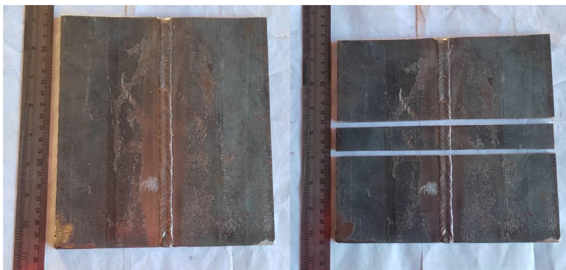
Figura 2. junta soldada antes do corte ( Autoria Própria) Figura 3. Junta depois do corte (Autoria Propria)
