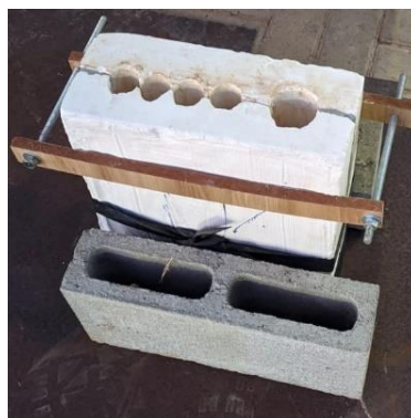
Figura 2 - Preparação do molde para o vazamento do alumínio (Autoria Própria).
