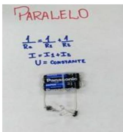
FIGURA 2. Protótipo: Circuito elétrico em Paralelo. (Autoria própria).
