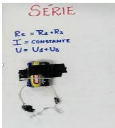
FIGURA 1. Protótipo: Circuito elétrico em Série. (Autoria própria).
