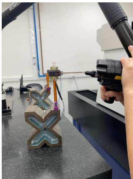
FIGURA 8. Utilização do braço scanner Hexagon (autoria própria).
