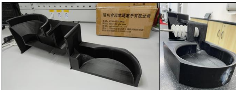
FIGURA 6. Meia impressão e impressão completa da base
